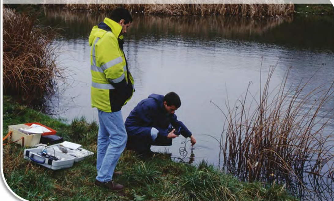
Prise de mesures physico-chimiques sur un bassin de rétention.
